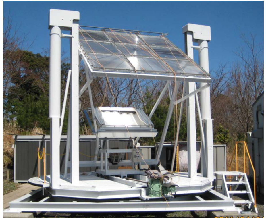
若狭湾エネルギーセンター フレネルレンズ方式
