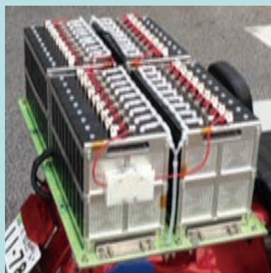
トライク (三輪車) 電池スタック例 (Mg BOX)
